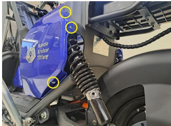
Irrota istuimen vasemmanpuoleisen alasivumuovin kiinnitysruuvit (ristipäämeisseli ph2).
