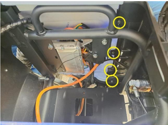
Irrota istuimen vasemmanpuoleisen alasivumuovin kiinnitysruuvit (ristipäämeisseli ph2).
