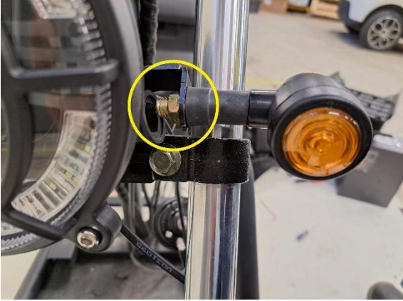
Irrota etuvilkun kiinnitysmutteri (kiintoavain 14 mm).
